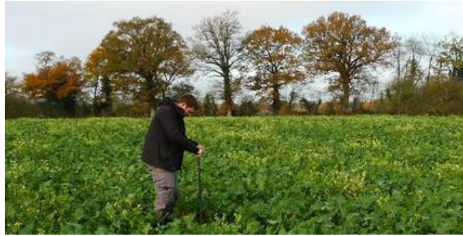
Prélèvement à l'aide d'une tarière pédologique © Calidris
