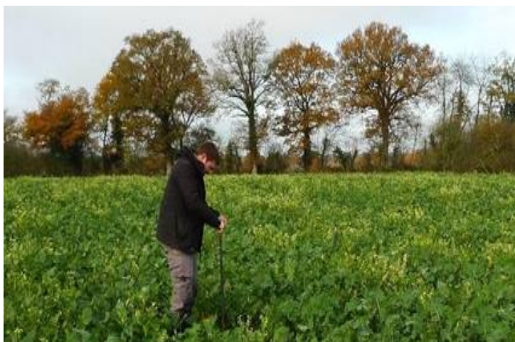
Photographie 4 : réalisation d'un sondage à l'aide d'une tarière pédologique
